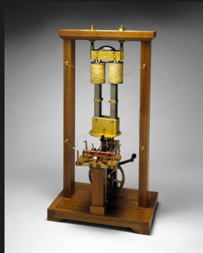
Machine à induction H. Pixii, 1832
