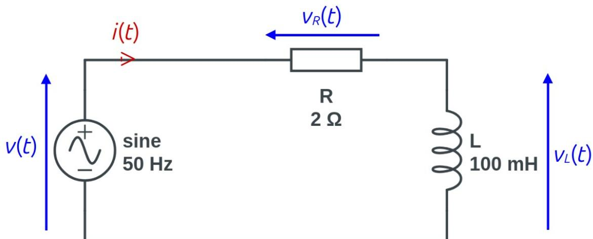
On précise que  $v(t) = V_{eff} \times \sqrt{2} \times \cos(\omega \cdot t)$  avec  $V_{eff} = 230 \text{ V}$  et  $\omega = 2 \cdot \pi \cdot f$
