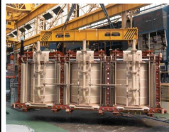
Transformateur en assemblage (noyau magnétique et enroulements)
