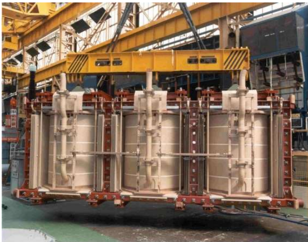
Transformateur en assemblage (noyau magnétique et enroulements)
