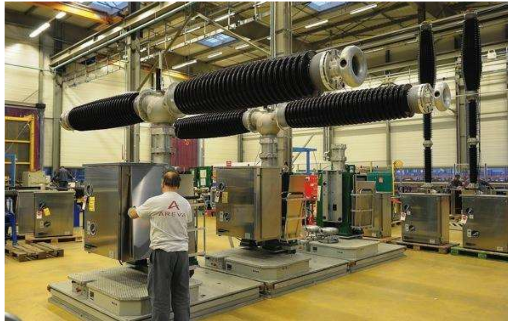
Usine de Villerbanne, fabrication de disjoncteurs
