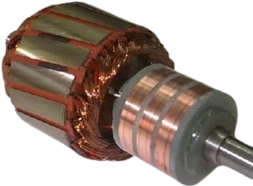
Les enroulements rotoriques sont reliés à des résistances externes via les bagues et des balais. Elles permettent de régler le déphasage entre la force électro-motrice induite et les courants induits dans les enroulements.
