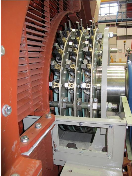
Machine Asynchrone à rotor bobiné
