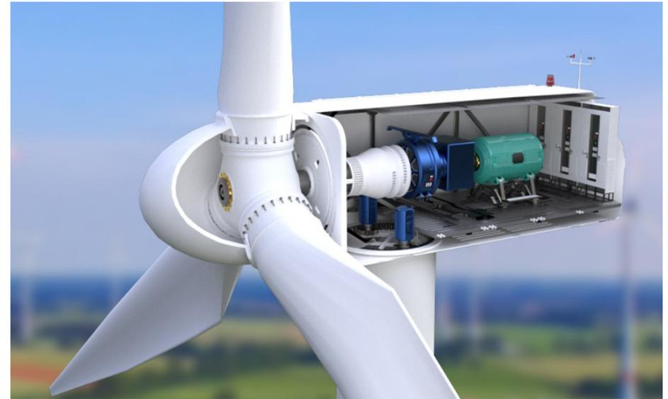
En mer (éolien *offshore*), on utilise plutôt des éoliennes à entraînement direct pour des raisons de légèreté et de simplification de maintenance.
