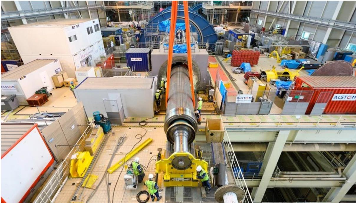
Stator 420 t au premier plan, Rotor en arrière-plan
