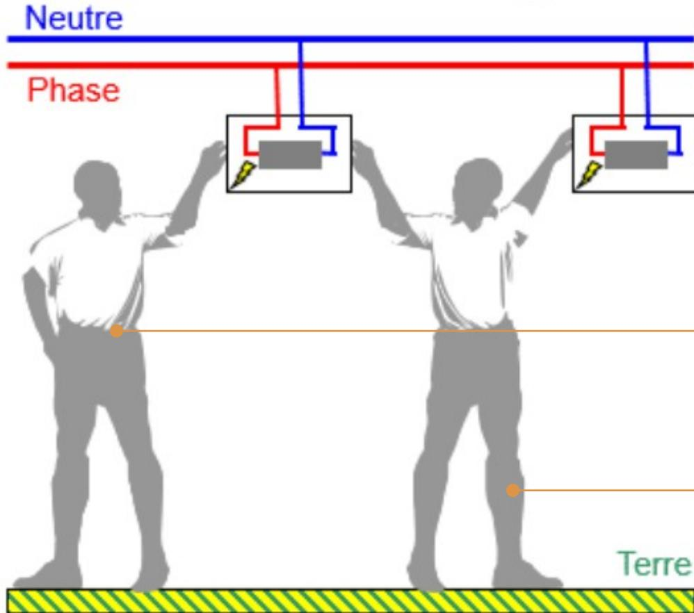
Le **contact indirect** se caractérise par le contact d'une personne **avec une masse accidentellement sous tension (défaut d'isolement)**.
