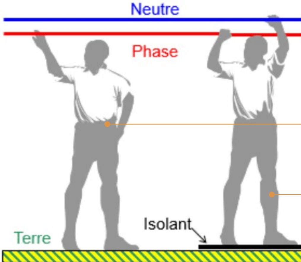
Le **contact direct** se caractérise par le contact d'une personne **avec une partie active** d'un circuit électrique.
