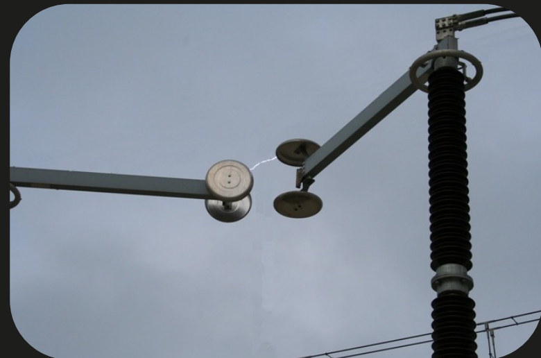
Arc formé sous une ddp de 400 kV
