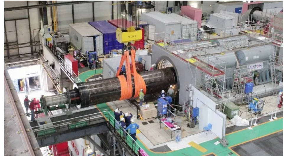
Rotor de l'alternateur du réacteur n°1 de Flamanville. Convoi de 67 m de long, 3 m de large, 450 tonnes pour maintenance.
