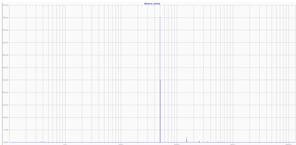
FIGURE 5 – Transformée de Fourier du courant sortant de la source de tension pour un montage à pont de diode sans condensateur de lissage.
