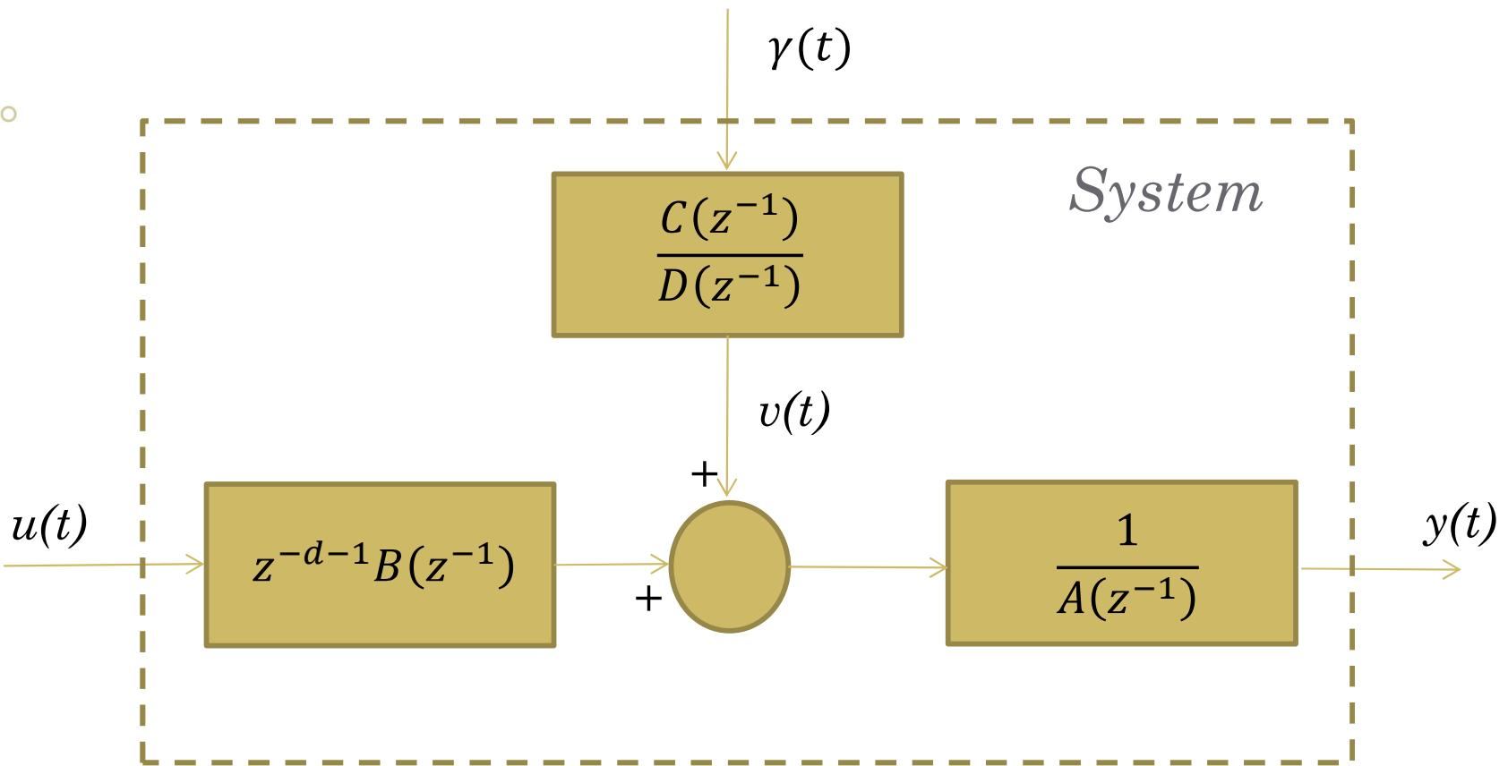
$$Y(z^{-1}) = \frac{z^{-d-1}B(z^{-1})}{A(z^{-1})} U(z^{-1}) + \frac{C(z^{-1})}{A(z^{-1})D(z^{-1})} \gamma(z^{-1})$$
