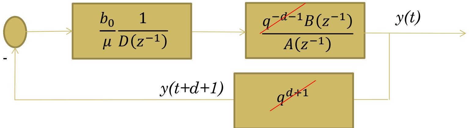
$$P_c(z^{-1}) = C(z^{-1}) \left\{ A(z^{-1})D(z^{-1}) + \frac{b_0}{\mu} B(z^{-1}) \right\} \Rightarrow P_c(z^{-1}) = A(z^{-1})D(z^{-1}) + \frac{b_0}{\mu} B(z^{-1})$$
