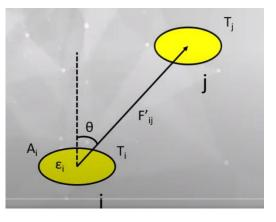
L'émissivité  $\varepsilon$  représente la quantité d'énergie émise par une surface (à T > 0K), et est définie comme le rapport entre l'énergie émise par une surface et l'énergie émise par un corps noire à la même température :  $0 < \varepsilon < 1$ .
