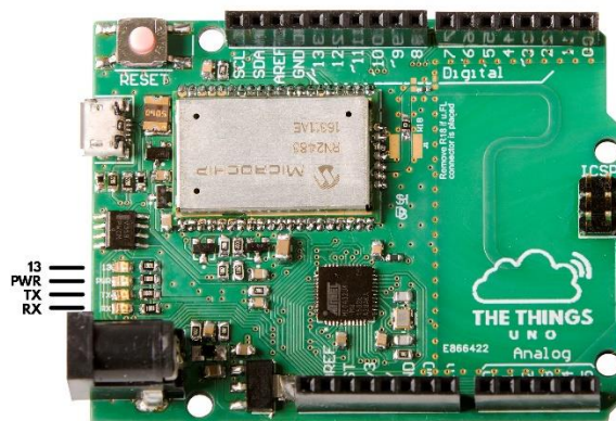
Figure 99 : Microcontrôleur ATMEGA + Module RN2483
