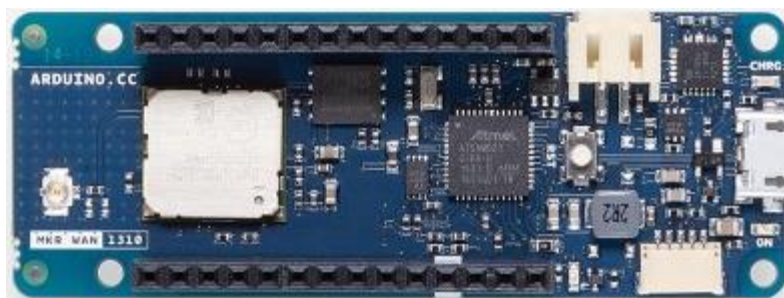
Figure 100 : Microcontrôleur ATMEL + Module CMWX1ZZABZ
